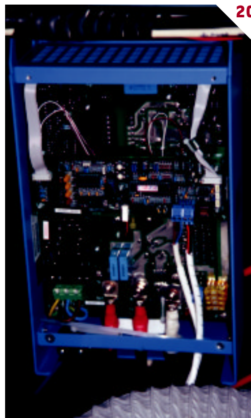
18 Detalle de un portafusible aéreo de poca intensidad. 19 Un espejo de reducidas dimensiones nos ayudará a ver los lugares de difícil acceso. 20 Detalle del interior de la placa del cargador con las conexiones terminadas 21 Vista parcial de las conexiones terminadas en un grupo de baterías. Puede apreciarse el fusible de 60 A, además del pequeño fusible secundario de 5 A conectado al sensor de voltaje. 22 Aspecto del cargador instalado. El led iluminado del panel indica que en ese momento trabajaba en la fase de absorción.
